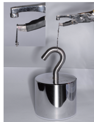
图2 利用砝码验证测量系统精度实验
