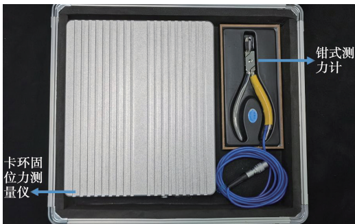
图4 可摘局部义齿固位力测量系统
